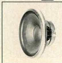
BGS 30 NG: 12"-basluidspreker van topkwaliteit. Zeer hoog belastbaar. Voor discotheken, orgels, keyboards en PA. Geschikt voor hoornkonstrukties en basreflexboxen. 200/300 watt, gemiddelde geluidsdruk 97 dB, 8 en 16 Ω.
